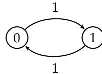
Abbildung 4.6: Eine Markov-Kette mit periodischen Zuständen
